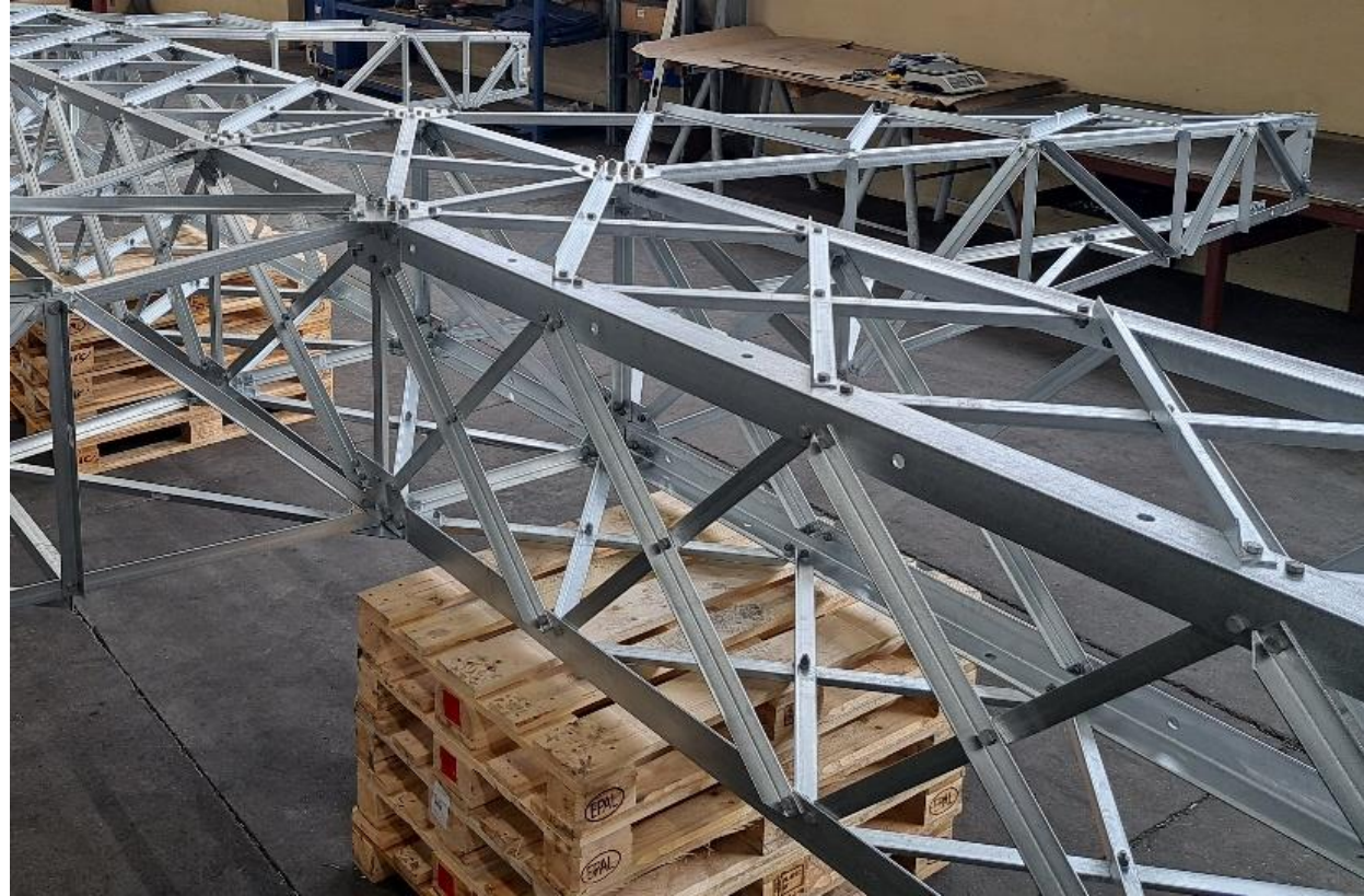
Słup żerdziowy ESHP1Dk/1073/15/1GD – elementy składowe
