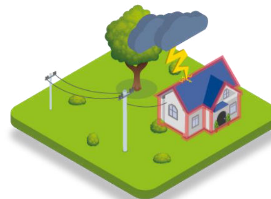
Bezpośrednie uderzenie pioruna w instalację odgromową
