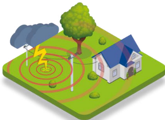
Bezpośrednie uderzenie pioruna w linie napowietrzną
